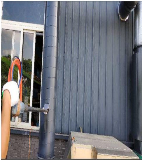
分装工序排气筒采样
