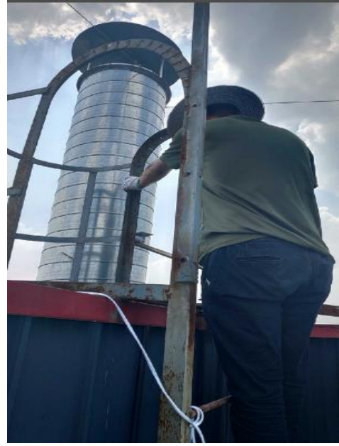
有机废气排气筒采样
