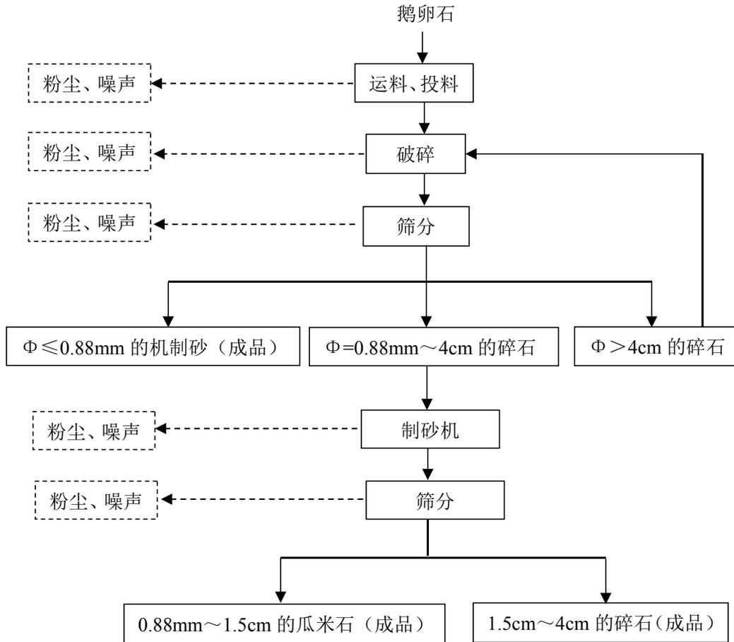
图 2-2 工艺流程及产污节点图
