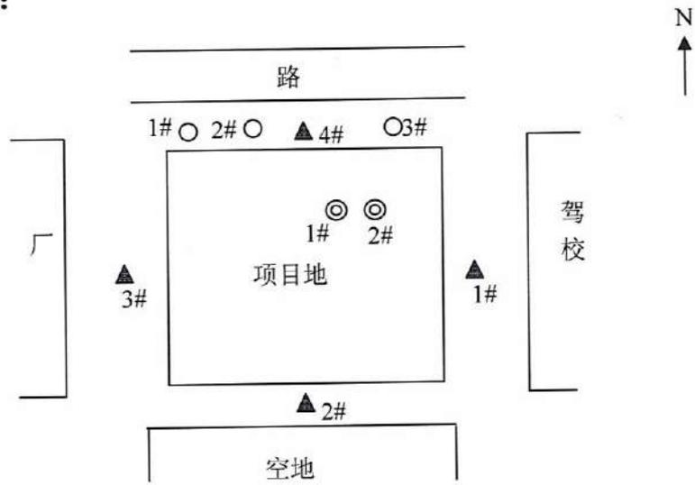
▲噪声监测点 ◎有组织排放废气监测点 ○无组织排放废气监测点
